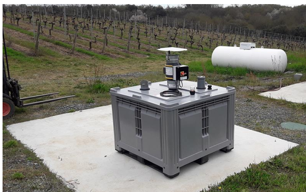
PHOTOS PHYTOGEST d'Agrys by Oceania-Dispositif de déshydratation par ventilation forcée -Mis en place sur une aire bétonnée.
